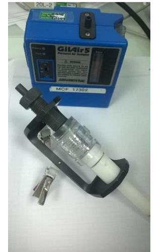
préleveur sur cassette pour les analyses de diffraction RX (Carsat).
