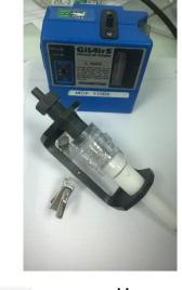
préleveur sur cassette pour les analyses de diffraction RX (Carsat).
