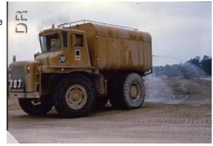
Matériels de chantier équipés de cabines pressurisées et de dispositif de filtration anti-poussières THE\*
